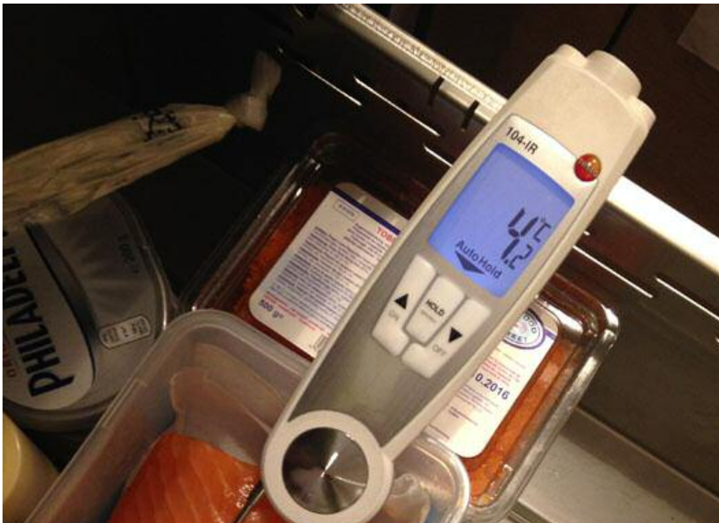
Abb. 21 Das Thermometer zur Temperaturmessung ist ein wichtiges Hilfsmittel auf Inspektionen.
