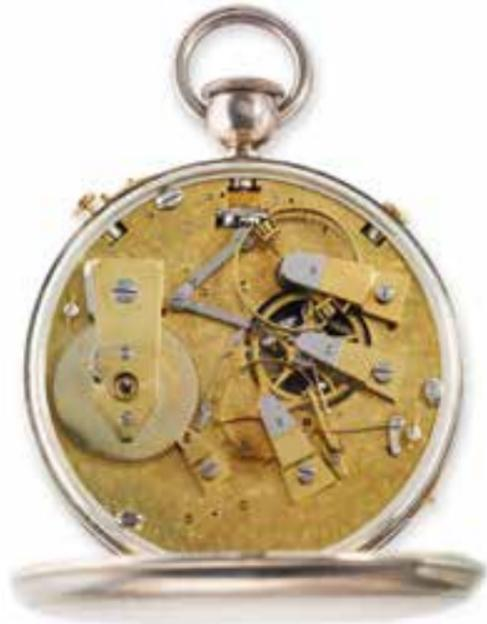
bust und sehr einfach zu bedienen war und bis heute verwendet wird, verdrängte es schliesslich definitiv. Dies war einer der wenigen Misserfolge von Breguet. Doch anstatt seine Erfindung aufzugeben, gab er ihr eine neue Bestimmung. So entstand ein Schrittzähler, der, wie er selbst sagte, eine Art Metronom sei, das der Truppe einen einstellbaren Schritttakt gebe.
