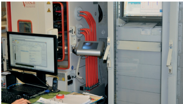
Prüfstand für Batterien unter verschiedenen klimatischen Bedingungen
